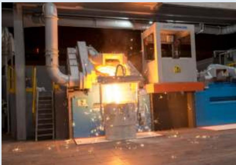
Плавка чугуна осуществляется: в двух индукционных тигельных печах средней частоты емкостью 1500 кг (фирмы Fuji Electric, (Япония), двух индукционных тигельных печах емкостью 3000 кг фирмы ОТТО JUNKER», (Германия) и двух индукционных тигельных печей средней частоты емкостью 3000 кг фирмы АВВ (Германия)
